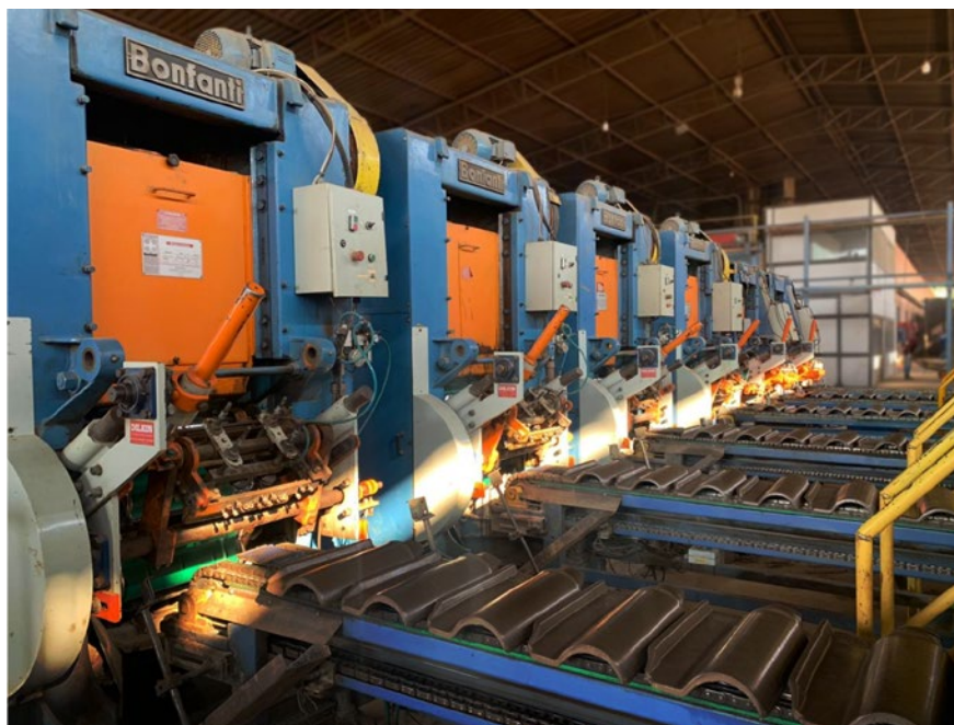
Prensa de telhas da Cerâmica Brasileira, de Minas Gerais
